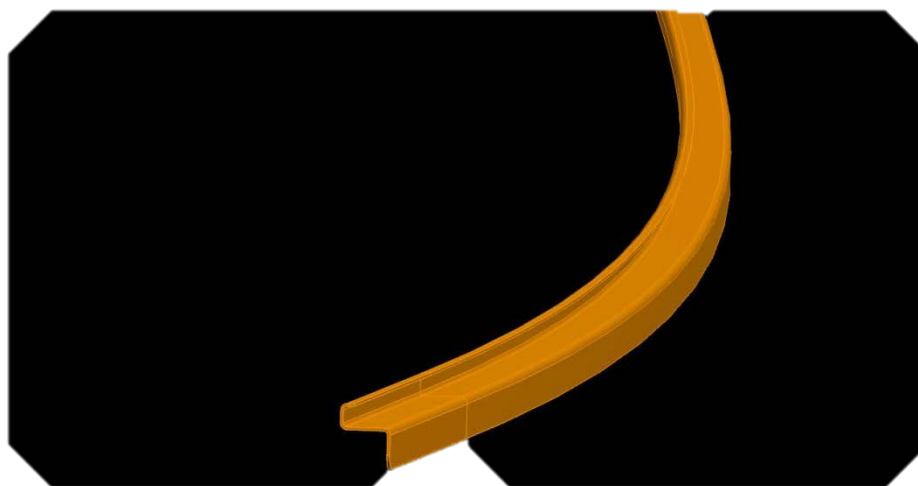
Рис. 2. 3D модель профиля для стрингера
