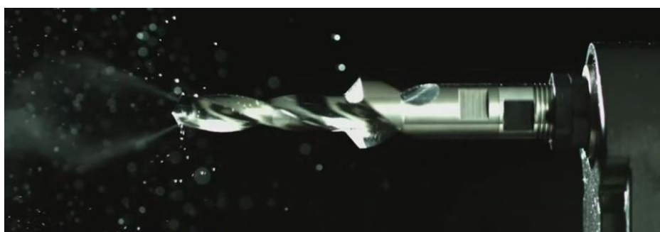
Рис. 10. Воздушно-смазочная смесь (MQL)
