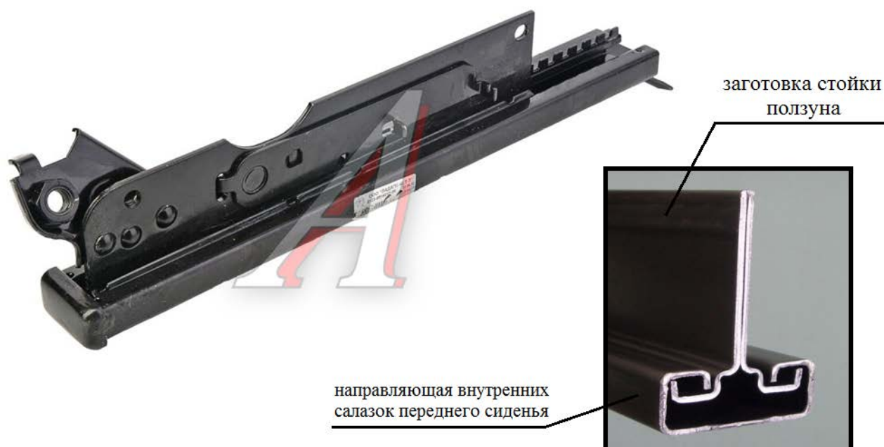
Рис. 1. Сборочный узел направляющих салазок регулировки передних сиденья для автомобиля
