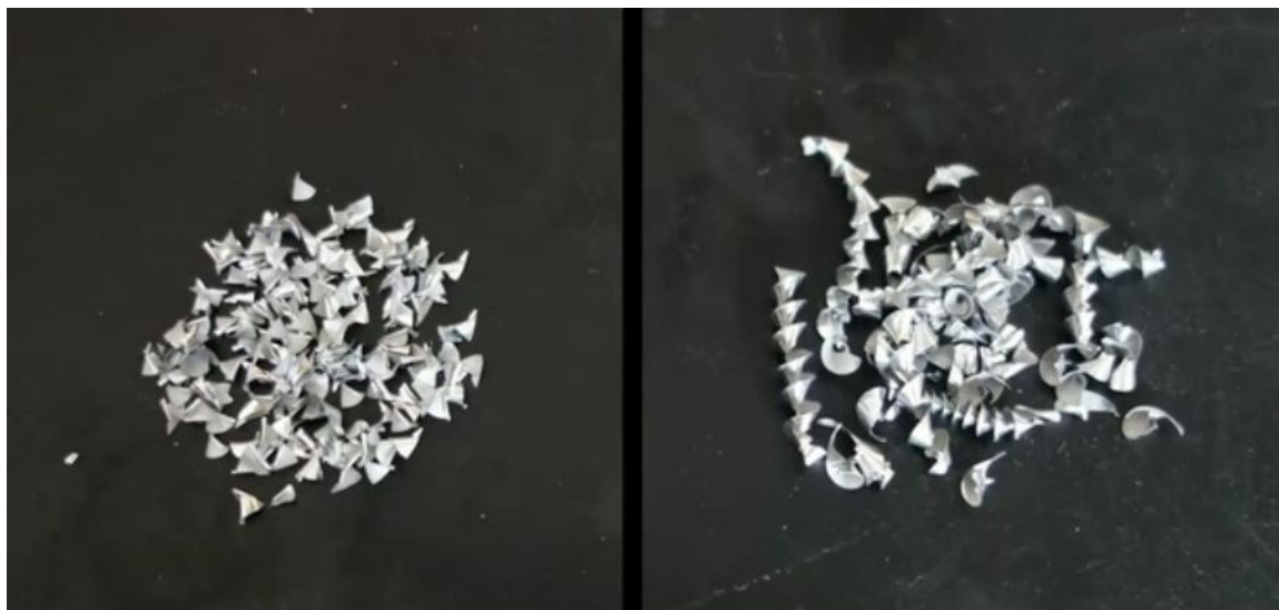
Рис. 9. Стружка при «кляющей» (слева) и постоянной подаче (справа)
