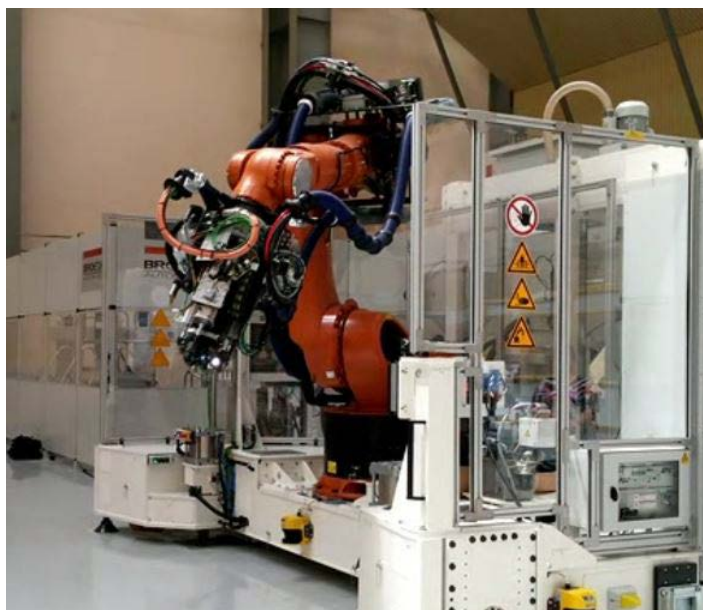
Рис. 7. Роботизированная платформа на базе робота ф. KUKA
