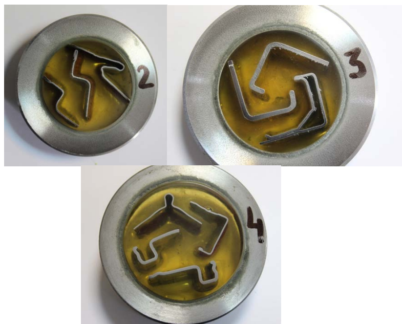
Рис. 4. Подготовленные шлифы для исследования структуры профилей
