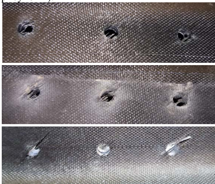
Рис. 1. Расслоения в местах выхода режущего инструмента
