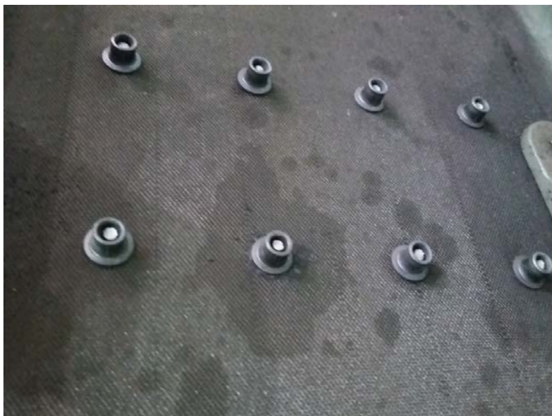
Рис. 8. Следы смазочно-охлаждающей жидкости на детали из углепластика
