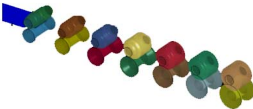
Рис. 4. Моделирование процесса формообразования гнутого профиля швеллерообразного типа
