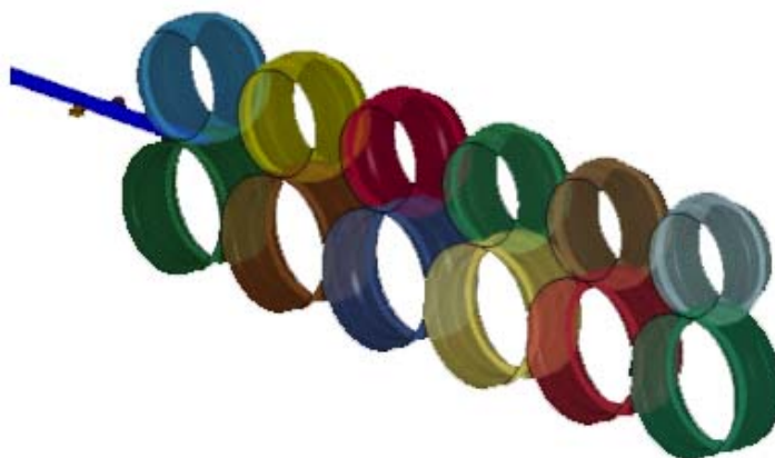
Рис. 5. Моделирование процесса формообразования гнутого профиля корытообразного типа
