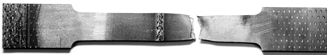
Рис. 3. Структура сварных соединений сплава ВТ23 (пластины в состоянии поставки)
