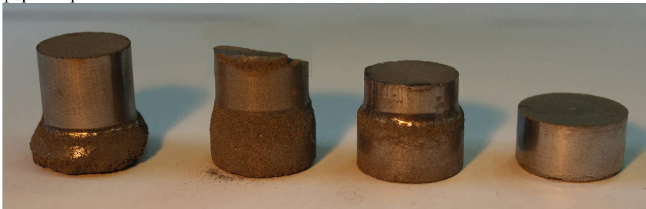
Рис. 3. Характерные этапы формообразования: 1 – первая стадия уплотнения; 2 – вторая стадия уплотнения; 3 – третья стадия уплотнения; 4- четвертая стадия уплотнения
