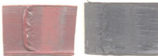
Рис. 4.91. Наплывы покрытия из полиуретана и пластизола толщиной более 50 мкм после обжима в роликах при \epsilon_z \approx 50 \%
