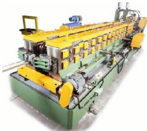
Рис. 1.50. Клеть с компоновкой «дуплекс» в профилегибочных агрегатах фирмы «Самко»
