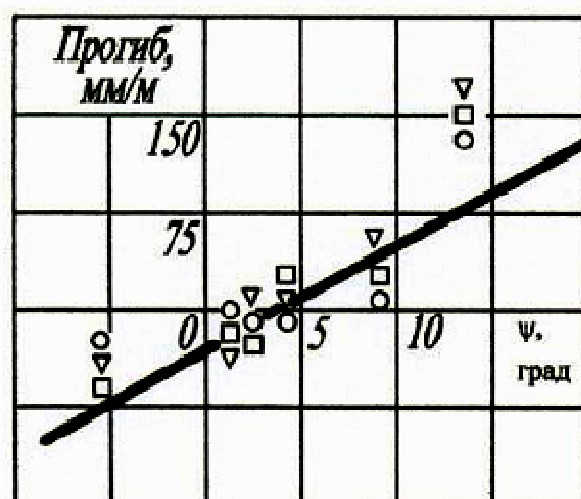
Рис. 4.85. Зависимость прогиба от угла захода: \circ – 1420, \square – Д16Т, \nabla – Д16М
