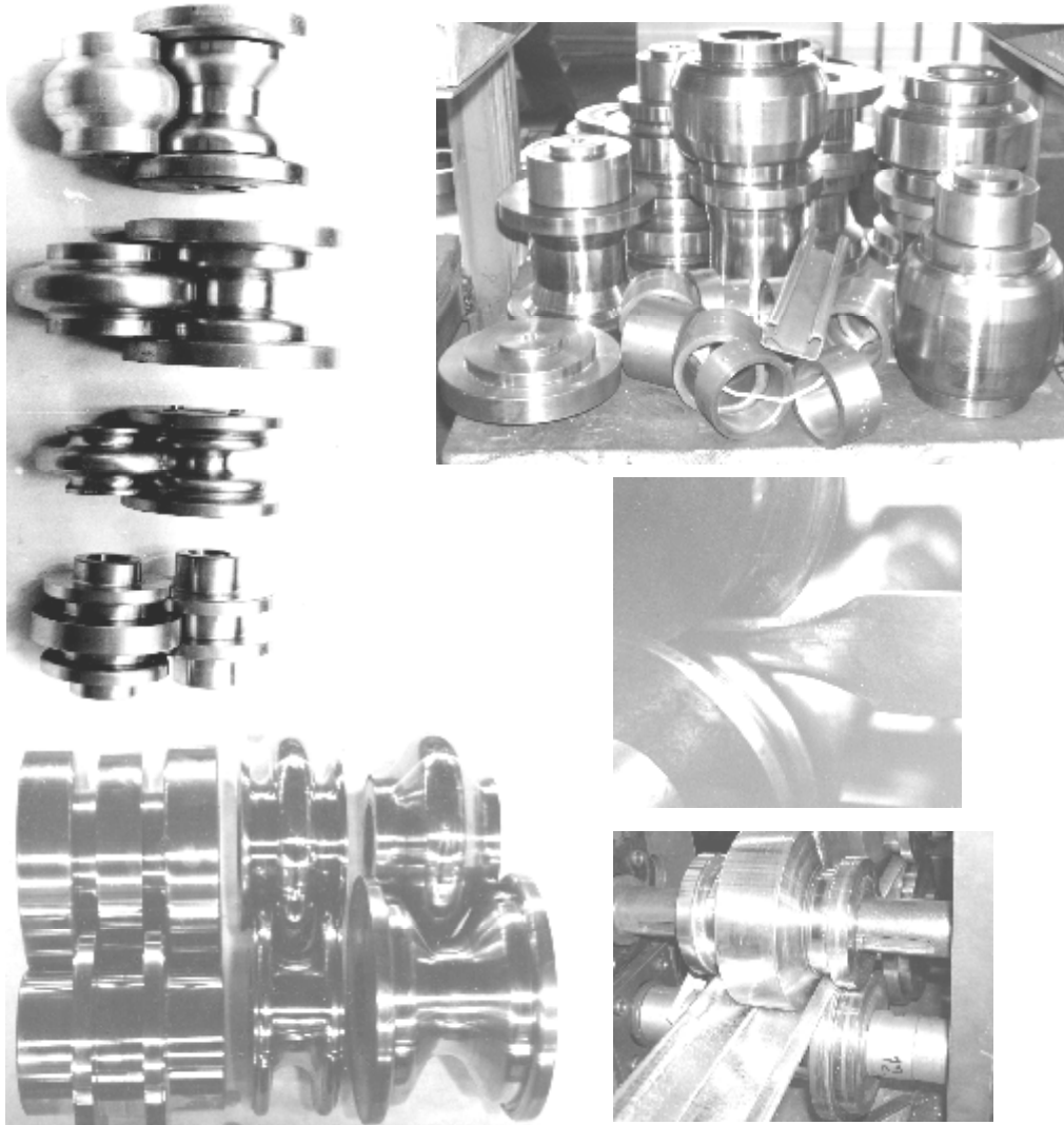
Рис. 6.45. Комплекты формирующих роликов для реализации технологии интенсивного формообразования
