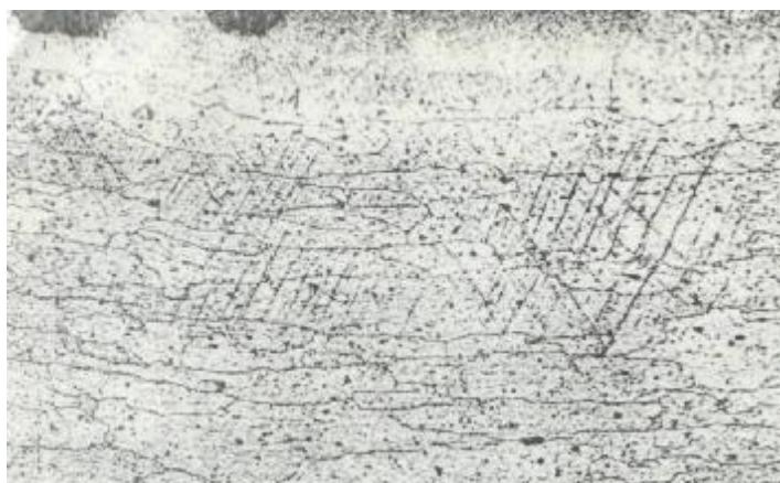
Рис. 4.26. Линии скольжения вблизи зоны сгиба на профиле из сплава В95
