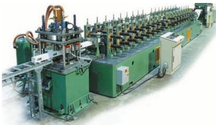
Рис. 1.49. Двухстоечная схема профилегибочного стана компании «Самко»
