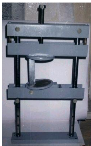
Рис. 4. 52. Экспериментальный пресс ПИГПЛУ-1: 1 – траверса регулируемая; 2 – траверса силовая; 3 – нижний установочный стол поворотный; 4 – замыкающий профиль; 5 – штифт силовой траверсы регулируемой; 6 – основание пресса; 7 – стойка – направляющая; 8 – винт нажимной; 9 – клин подвижный; 10 – штифт-ось нижнего установочного столика; 11 – пружина возвратная; 12 – шплинт штифта-оси 10; 13 – винт крепежный; 14 – винт перемещения клина регулировки угла поворота столика 3
