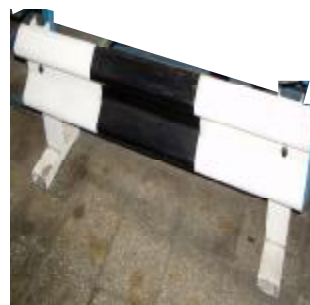
Рис. 1.15. Образец профиля дорожно-го ограждения
