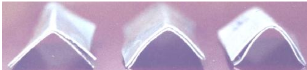
Рис. 4.17. Расслоение заготовок композита при гибке в роликах
