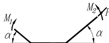
Рис. 1.62. Схема действия силовых факторов на полки
