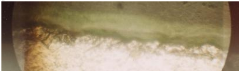
Рис. 4.90. Зона сцепления субстрата и покрытия после обжима в роликах
